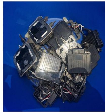
Scatole di giunzione
